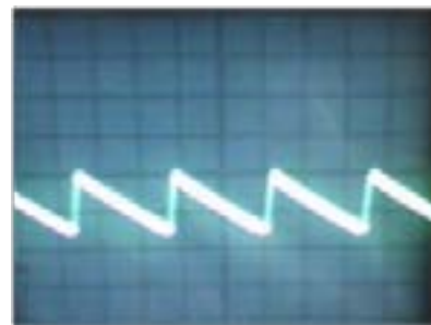
Figura 3 – Forma de onda para diodo rápido
