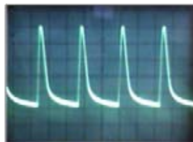
Figura 2 – Forma de onda para diodo comum
